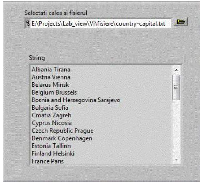
Dupa cum se observa pe panoul frontal, pentru selectarea fisierului, s-a plasat un control de tip "Path" dispus in grupul Controls => Modern => String & Paths => File Path Control
