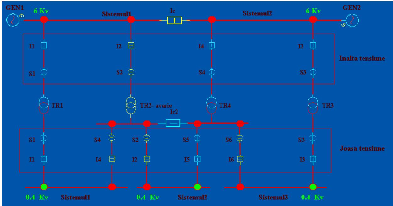
Dupa schema de mai sus se poate observa ca TR1 a fost declarat capabil de a fi functionata din nou in conditii normale si de a alimenta sistemul 1 de bare astfel AAR a repus in functiune transformatorul pentru a alimenta consumatorii. In acest fel transformatorul 4 ramane doar sa alimenteze sistemul 2 de pe JT.
