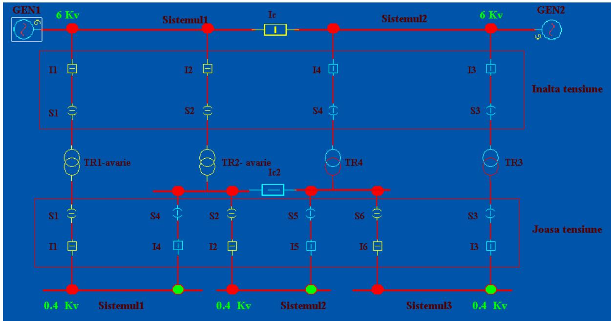
Alimentarea sistemului 2 si a sistemului 1 in aceasta configuratie se poate realiza doar prin inchiderea intrerupatorului de cupla Ic2.
