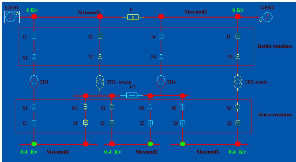
In aceasta configuratie se poate observa ca nu exista variante de avarie in care sa ramana sistemele de bare de pe joasa tensiune nealimentate. Doar in cazul in care 3 transformatoare ar ajunge in stare de defect in acelasi interval de timp. Acest caz este imposibil.
