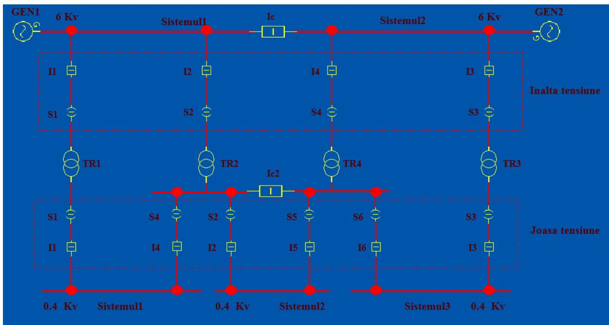
Intr-o schema normal de functionare alimentarea sistemelor 1,2,3 este realizata prin trasnformatoarele TR1, TR2 si TR3, TR4 fiind de rezerva.
