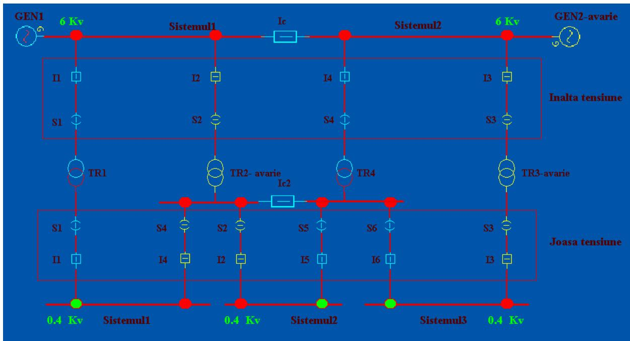
Aceasta configuratie si cu ajutorul automatizarilor sa fie aproape imposibila varianata in care sa se ramana nealimentat vreun system din cauza unui defect ori a transformatoarelor ori a liniilor electrice care alimenteaza sistemele 1 si 2 de IT.
